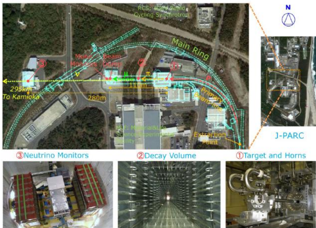
Рис.2. Нейтринный комплекс в J-PARC. Протонный пучок, выведенный из основного кольца J-PARC, взаимодействует с графитовой мишенью (1). Рожденные в мишени пионы фокусируются системой импульсных магнитов и затем распадаются на мюоны и мюонные нейтрино (антинейтрино) в распадном объеме длиной 100 метров (2). Параметры нейтринного пучка до осцилляций измеряются и контролируются ближним нейтринным детектором, расположенным на расстоянии 280 м от мишени (3).
